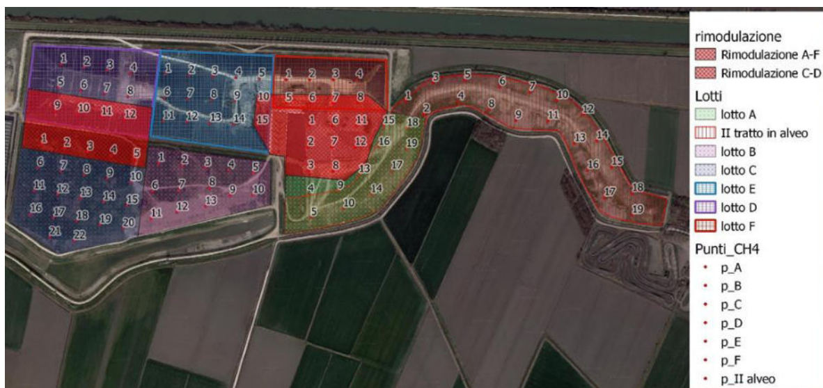
Figura 4 planimetria della discarica di Legnago con evidenziati i punti di indagine per il metano superficiale.
